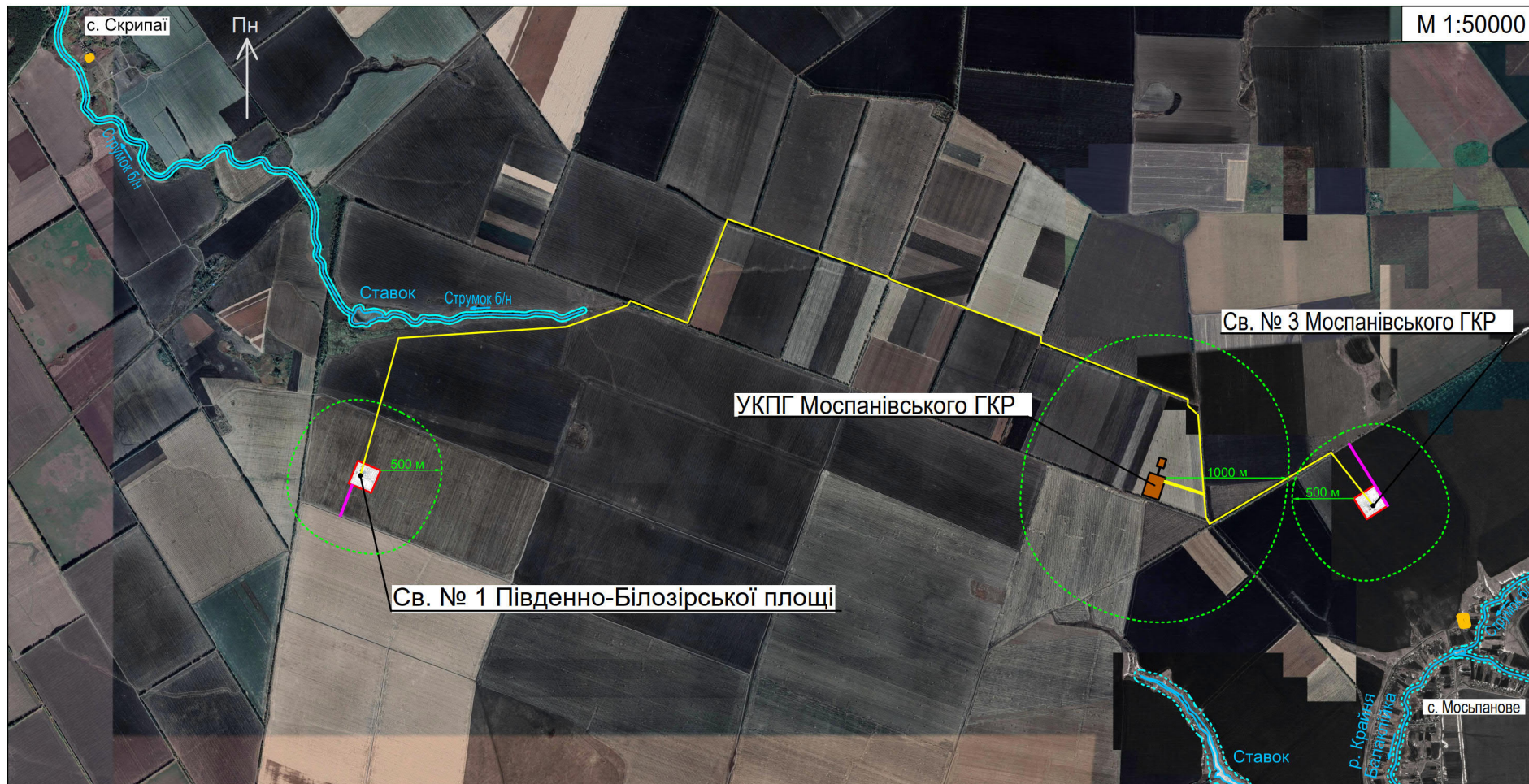
Рисунок 1.1.2 – Ситуаційна карта-схема розташування проектних свердловин, під'їзних доріг і трас газопроводів-шлейфів підключення проектних свердловин
